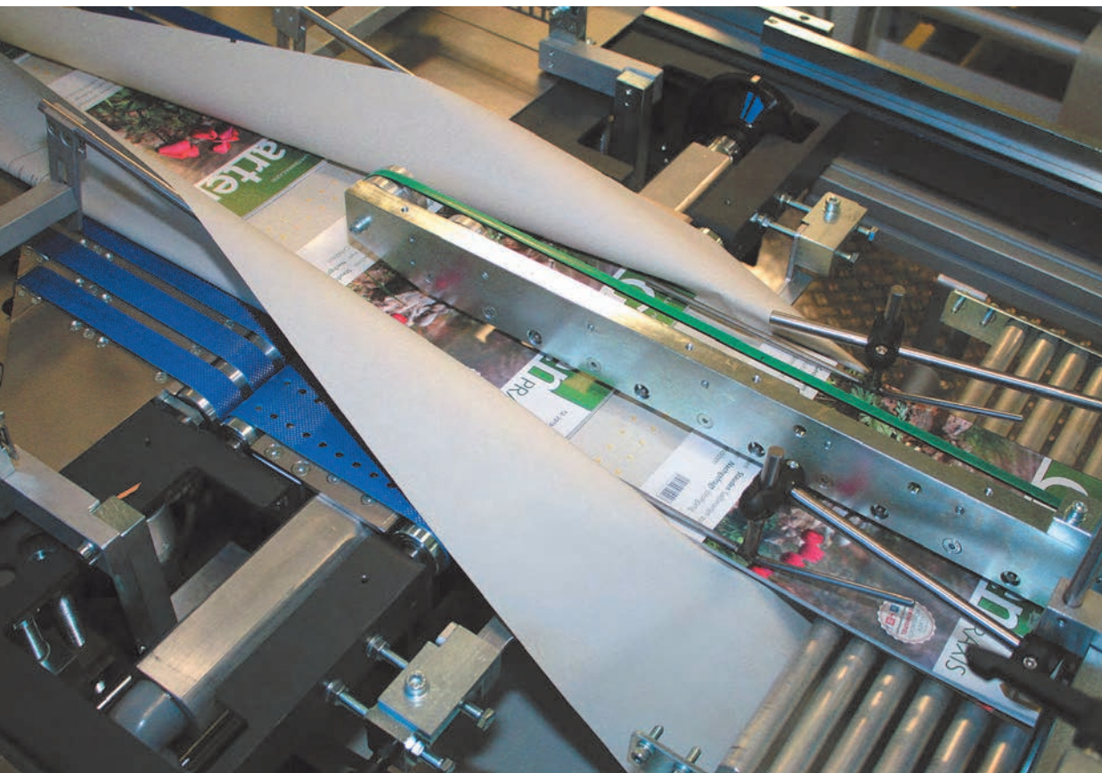
Verarbeitet werden auf der neuen Maschine Folien aller Arten und Papiere ab etwa 60 g/m 2 bis zu 120 g/m 2 (Im Bild verarbeitet wird Papier 77 g/m 2 matt). (Bild: Judith Grajewski)
