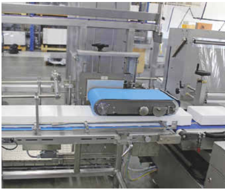
Pressband und Eintaktung von Produkten auf einem Transportband in Balkon-Bauweise
