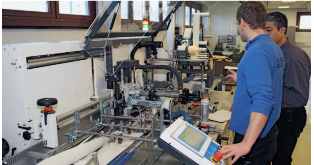
Die Papierverpackungsanlage basiert auf der „Paper X Hybrid Advance“ und wurde in Zusammenarbeit mit Kohlhammer Druck um mehrere Aggregate erweitert (siehe Kasten Seite 20). Wenn die Anlage in Obertürkheim aufgebaut wird, misst sie fast 26 Meter in der Länge und kann viel mehr als nur in Papier verpacken.
